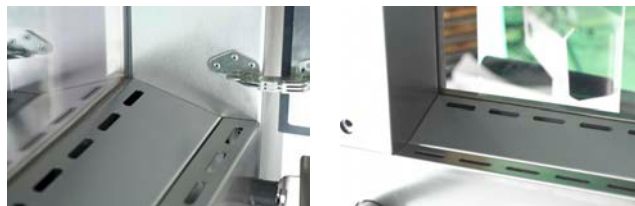
Grâce à ses rebords inclinés l'espace entre les deux vitres permet de limiter l'accumulation de résidus et un nettoyage parfait.
