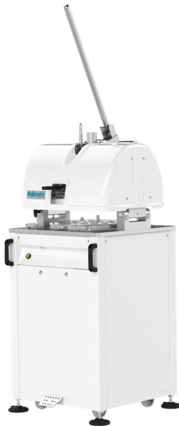
Spezza arrotondatrice manuale. Per ridurre l'ingombro e renderne più ergonomico l'utilizzo, al posto della tradizionale maniglia per attivare il ciclo di arrotondamento, il modello DR-M è fornito di pedaliera. Grazie alle maniglie frontali ed al carrello azionabile a leva(opzione), la macchina può essere facilmente sollevata sulle ruote e spostata per la pulizia del pavimento
