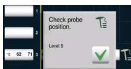
Si la sonde a été insérée de manière incorrecte ou si elle a glissé lors du contrôle de cuisson par niveau, le message suivant apparaît.
