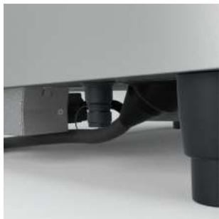
L'interface LAN se trouve sur la face inférieure de l'appareil, du côté gauche (sur le modèle XS, elle se situe à l'arrière de l'appareil, du côté droit).
