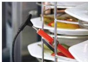
Pour le **Finishing®** avec le cadre porte-assiettes, insérez la sonde de température à cœur dans le tube en céramique sur le cadre du porte-assiettes.
